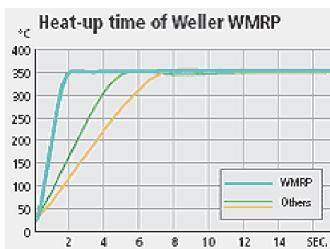
Паяльник WMRP – это паяльник, у которого жало и нагревательный элемент является единым целом, что позволяет получить минимальное время разогрева и максимальную точность поддержания температуры.
